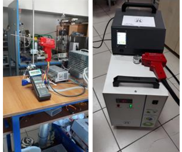
Şekil 1. Termoelektrik kriyo iğne ve test düzeneği
