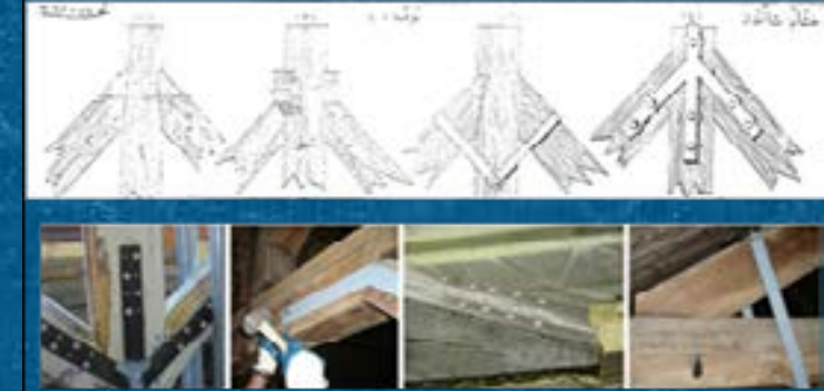
Görsel 3. Ahşap- ahşap arası metal şeritlerle birleşimler: üstteki resim Ali Talat Bey tarafından çizilen birleşim detayı (Ali Talat Bey, 1925); alttaki resim günümüzde restorasyon çalışmalarında uygulanmış yeni metal şeritler ile birleşim detayı (Branco, ve diğ., 2018).
