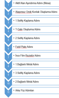
Şekil 1: GaN HEMT Fabrikasyon Adımları
