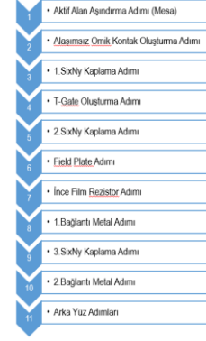
Şekil 1: GaN HEMT Fabrikasyon Adımları
