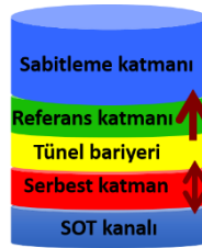
Şekil 1: MTJ yapısının şematik gösterimi
