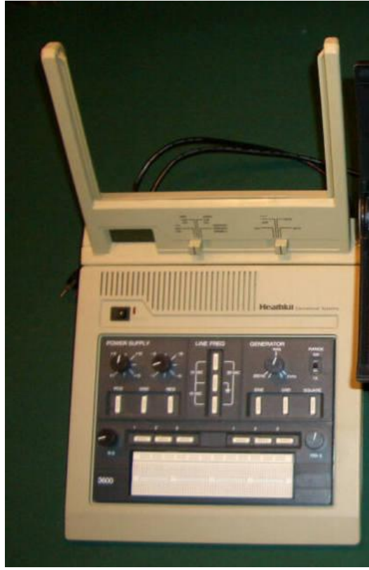
ekil 2 ETW-3600 ve ETW-3567 Deney seti
