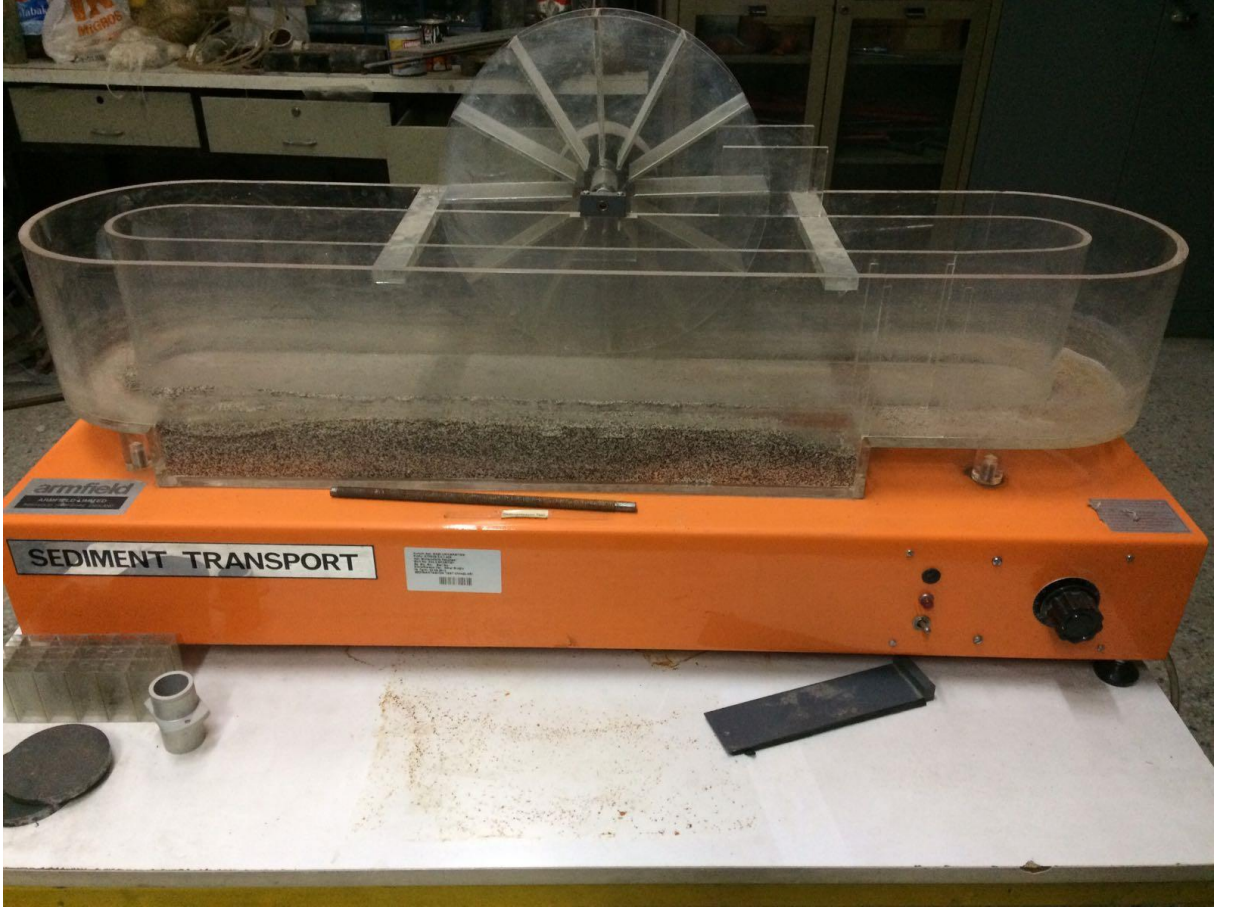
Resim 5: Sediment taşınımı deney düzeneği
