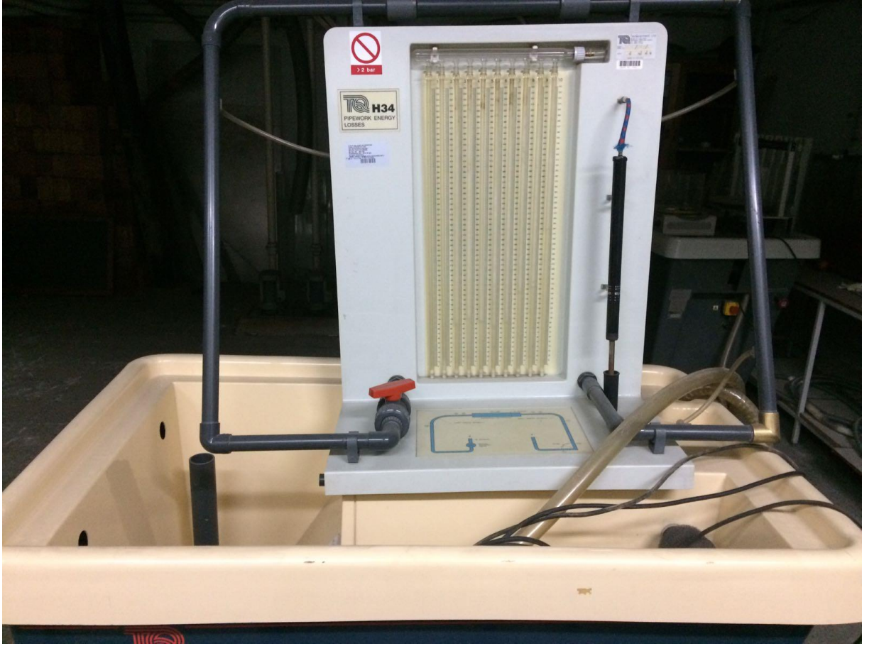
Resim 8: Boru akımlarında yerel kayıp deney düzeneđi
