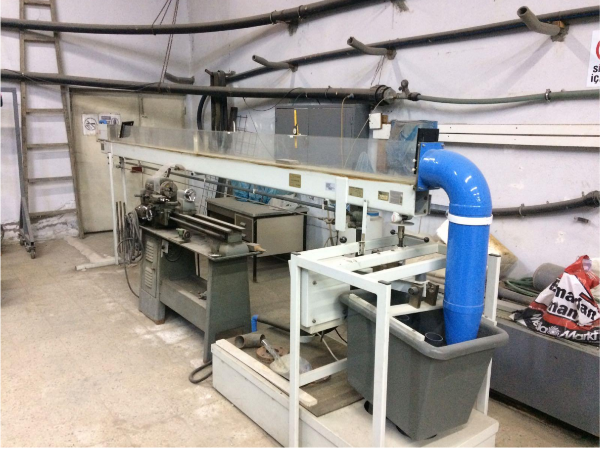
Resim 9: Açık kanal akımı deney düzeneği
